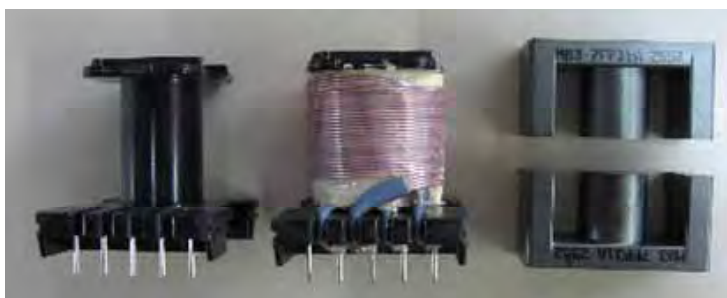
写真2 ボビン, ボビンに巻線をした状態, コア
